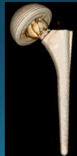
Reconstrucción con TC 3D donde se aprecia la rotura de la cabeza cerámica
